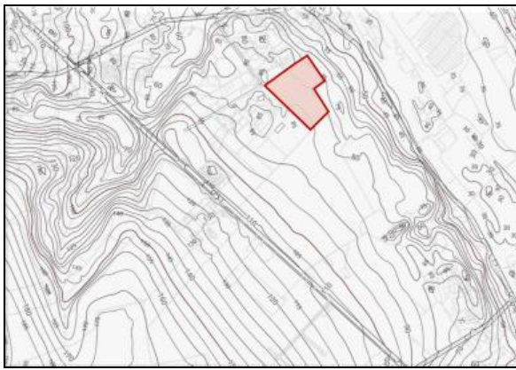
Рис. 1.1 Топографическая съёмка территории для многофункционального медицинского центра. Разработано: автором
