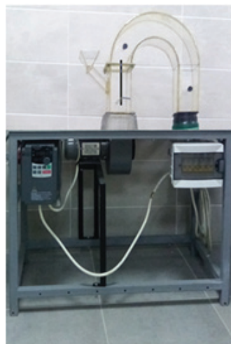
Figura 1. Instalația experimentală elaborată pentru uscarea semințelor (foto)
