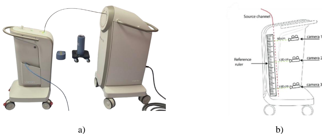
Figura 1. Dispozitivul de verificare a poziției (CamScale) pentru sistemul de brahiterapie BRAVOS: a) amplasarea CamScale-ului față de BRAVOS; (b) desen schematic care indică poziția camerelor și a riglei utilizate pentru verificarea poziției în CamScale [5].
