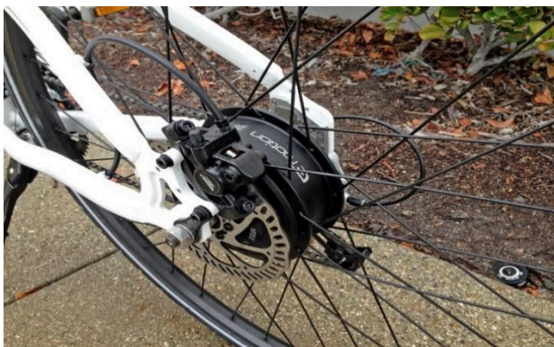
Fig. 5. Motor electric, montat direct pe roata
