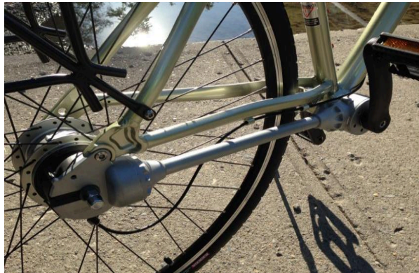
Fig. 6. Transmisie prin roți dințate, fără lanț
