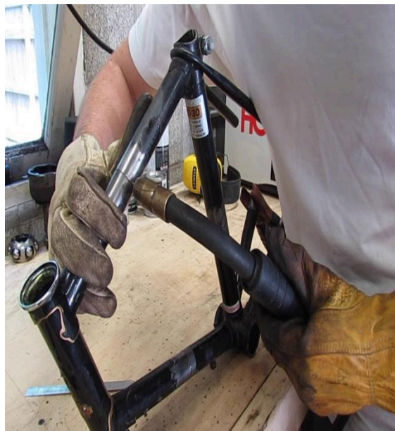
Fig. 4. Sudarea cadrului de bicicleta
