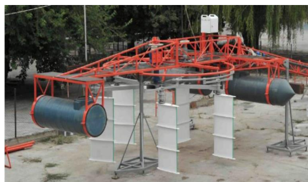
Fig. 27. Vederea generală a microhidrocentralei de flux cu rotor hidrodinamic basculant cu 5 pale cu lungimea cordului c=800\text{ mm} și ecrane pentru direcționarea curgerii fluidului.
