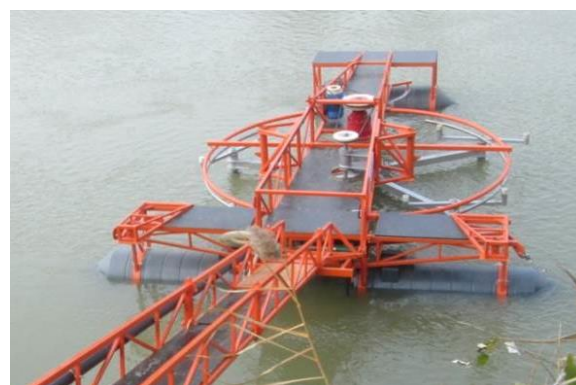
Fig. 29. Microhidrocentrală de flux cu rotor hidrodinamic basculant cu 5 pale instalată pe râul Prut (comuna Stoieniști, Cantemir, 2013).
