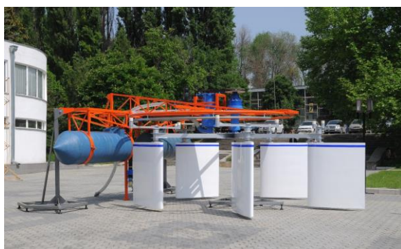
Fig. 26. Microhidrocentrală cu rotor hidrodinamic pentru conversia energiei cinetice a râului în energie mecanică utilizată pentru pomparea apei (debitul Q=40\text{ m}^3/\text{h} , înălțimea pomparei H=10-15\text{ m} ).
