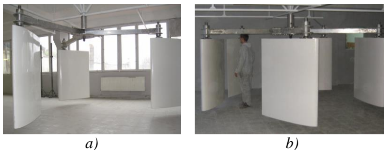
Fig. 22. Rotoare cu trei (a) și cinci (b) pale cu profil hidrodinamic, fabricate în Laboratorul Centrului de Elaborare a Sistemelor de Conversie a Energiilor Regenerabile, UTM.
