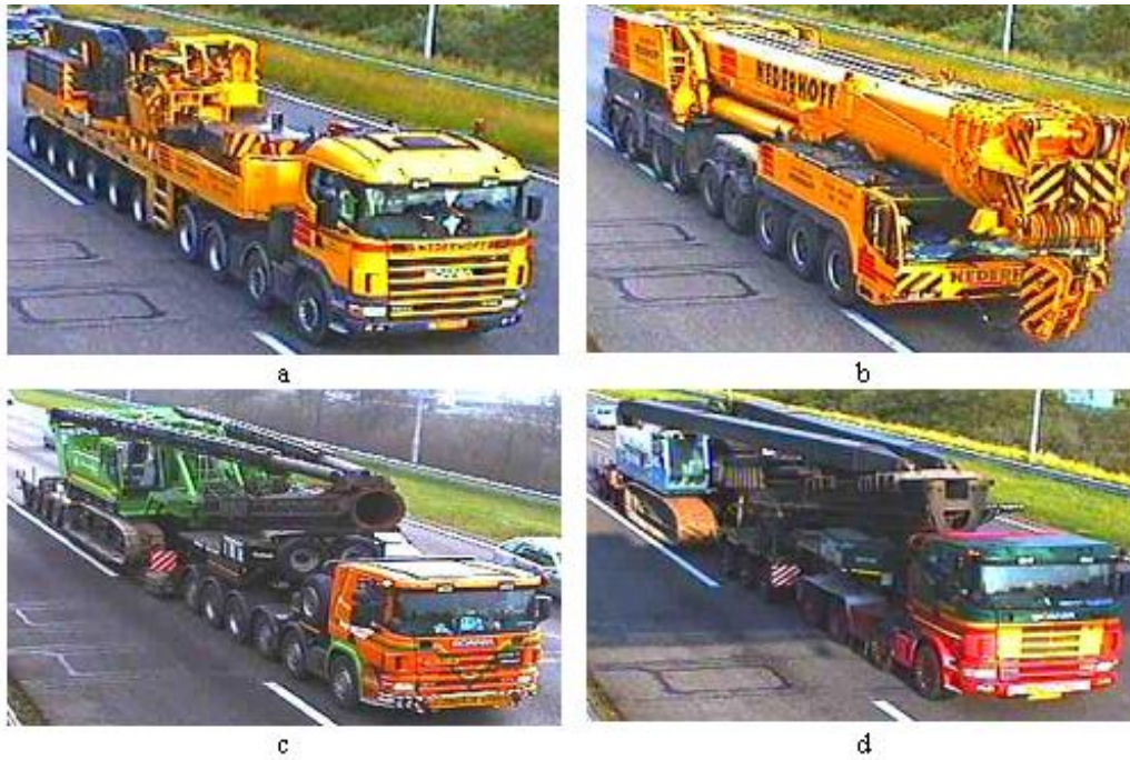
Fig. 2. Automacarale având greutatea proprie/ nr. de punți: 1100 kN/10 punți (a); 1110 kN/9 punți (b); 1450kN/11 punți (c); 1650kN/12 punți (d)
