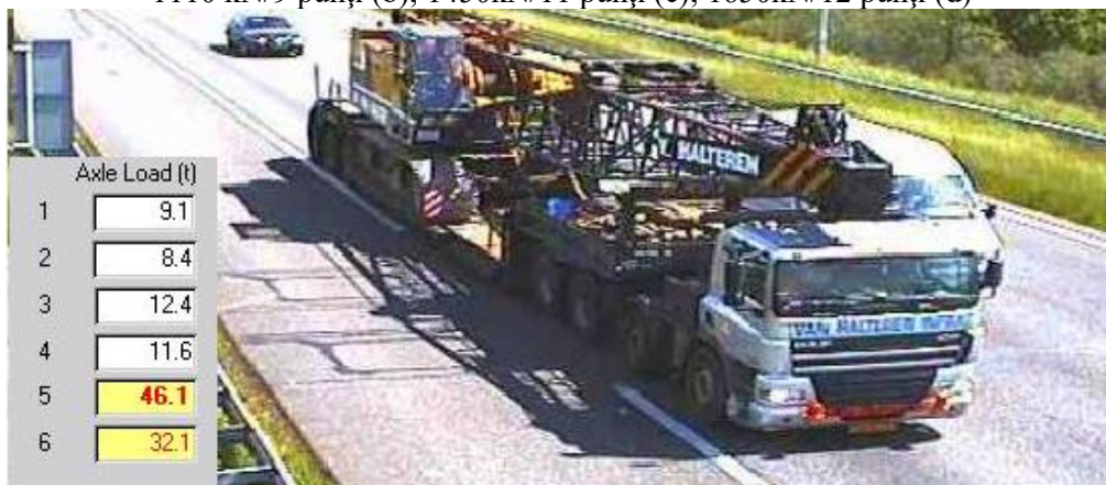
Fig. 3. Determinarea cu senzori WIM [10] (cântărire în mișcare) a încărcării pe punțile unei automacarale: deteriorarea șoselei este D=(451,78/82)^4=921,41 , conform ecuației (21)
