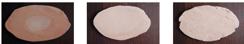
Fig. 3. Amprente formate în cazul uscării, pe un suport acoperit cu material textil, a vaselor modelate.
