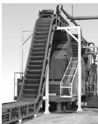
Figura 2 - Linie tehnologică de mărunțire a anvelopelor
