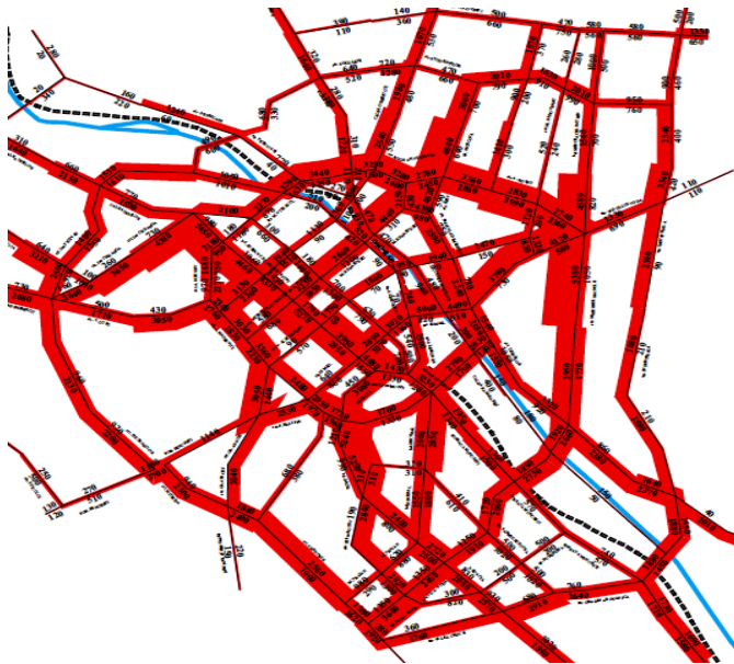
Fig.2. Exemplu de diagramă a fluxurilor de pasageri (cererea de transport) în orele de vârf pentru condițiile sistemului de transport public al orașului Chișinău, pasageri/oră
