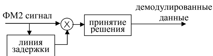
Рис.2. Дифференциальный демодулятор ФМ2 сигнала
