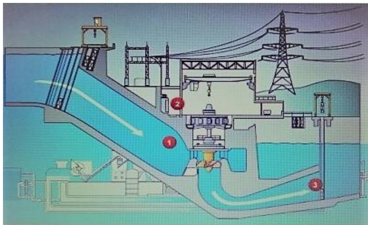
Figura 6 Barajul unei hidrocentrale unde este reprezentat principiul de funcționare a generatorului cuplat cu o turbină
