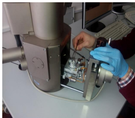
Fig. 8. Pregătirea încercărilor cu ajutorul SEM
