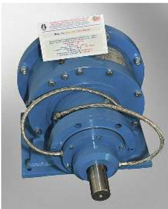
Fig. 6.41. Module electromecanice de acționare a aerliftului
