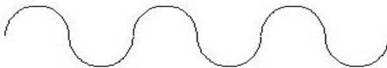
Fig. 6.23. Mișcarea oscilatorie a sculei, determinată de amplasarea ei pe un dorn cu excentricitate
