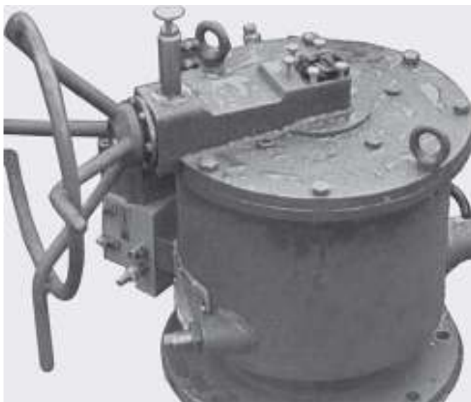
Fig. 6.43. Turbomotor precesional reactiv cu ejecție a armăturii pentru magistrale de gaz: a) desen tehnic; b) prototip industrial fabricat), c) turbomotor agregatizat cu conducta de magistrală
