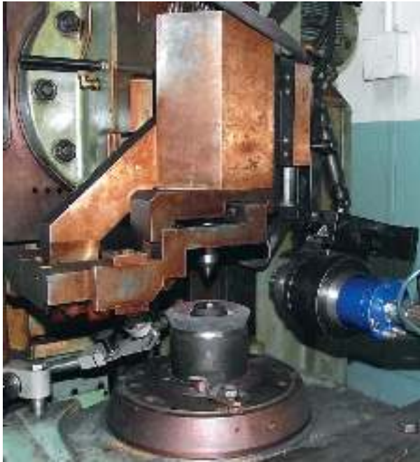
Fig. 3.18. Mașină-unealtă 53A30P cu dispozitivul de generare prin rectificare a danturilor cu sculă precesională în formă de disc
