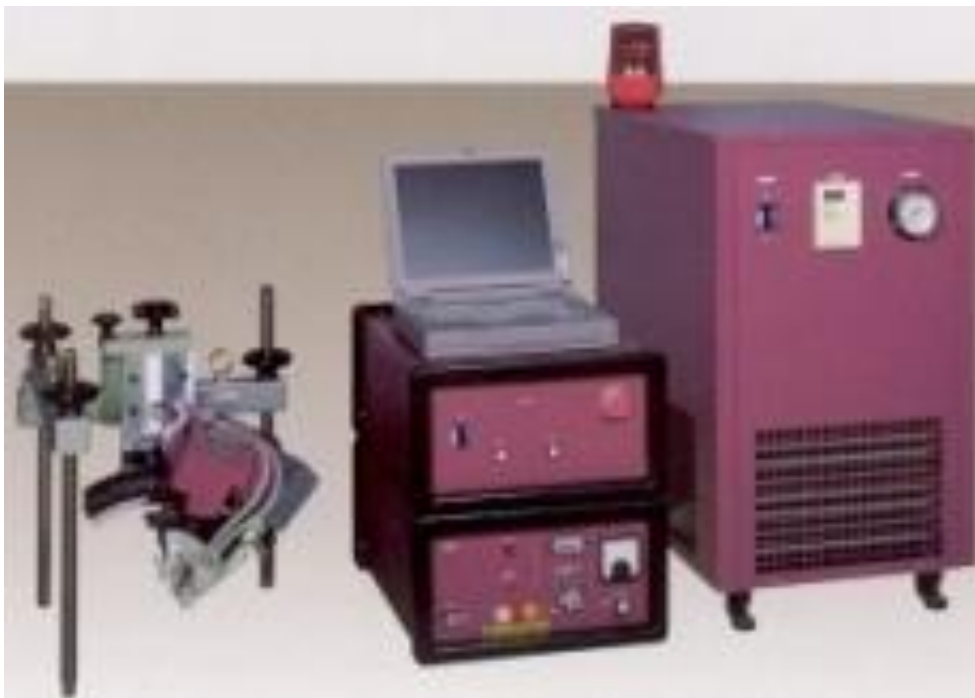
Fig. 5.3. Difractometrul MSF/PSF-3M pentru analiza tensiunilor remanente
