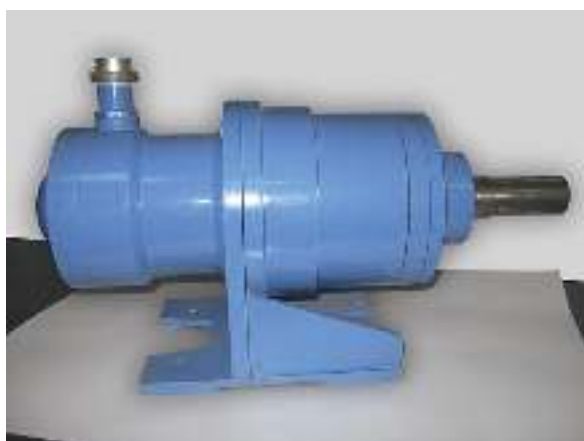
Fig. 6.40. Module electromecanice de acționare a aerliftului
