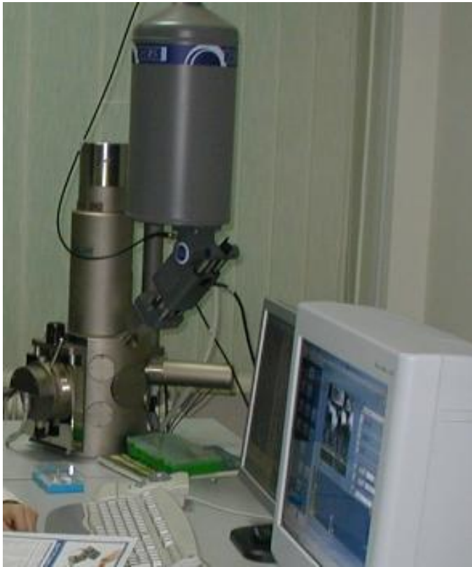
Fig. 5.2. Microscop electronic cu scanare VEGA TS 5130
