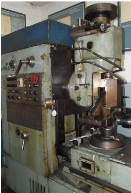
Fig. 11. Mașina-unealtă 53A30P și dispozitivul central de danturat
