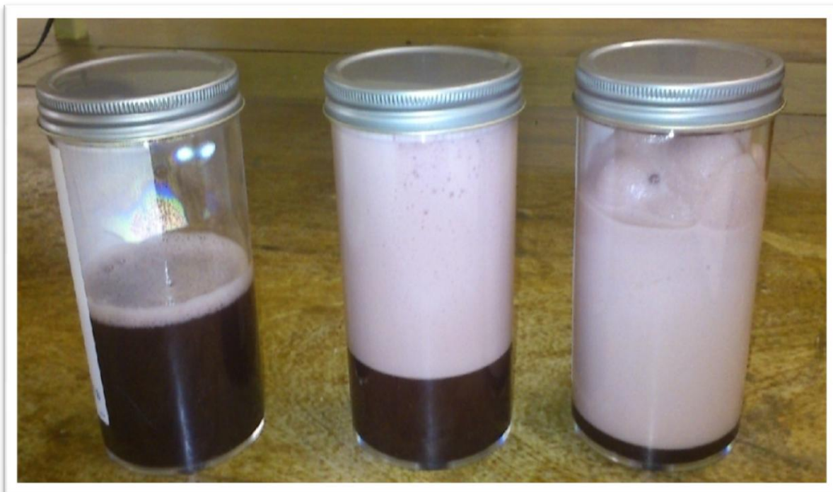
Fig. 4.3. Faza lichidă și faza spumă obținute după procesul de separare (Imagine: arhiva personală)
