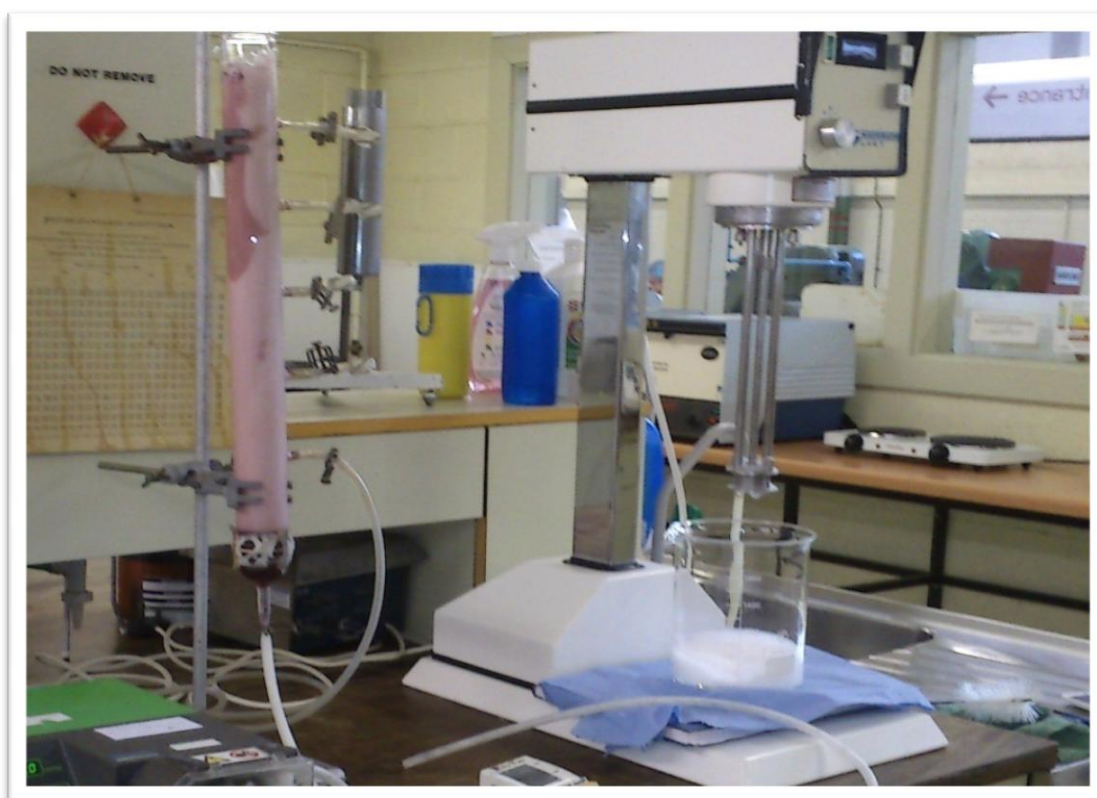
Fig. 2.5. Instalația utilizată pentru separarea polifenolilor folosind microspuma coloidală în laboratorul Universității din Reading (Imagine: arhiva personală)
