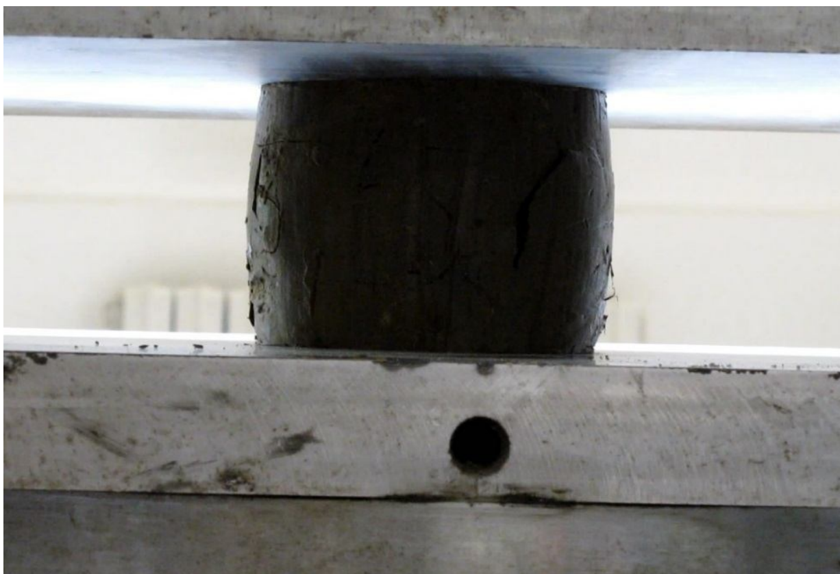
Fig.2.26. Încercarea mostrei la compresiunea monoaxială
