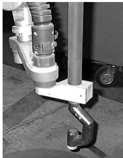
Fig.2. Cap tipic pentru taierea robotizata cu arc de plasma.
