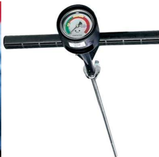
Фото 11.18. Пенетромтр для определения уплотнения
