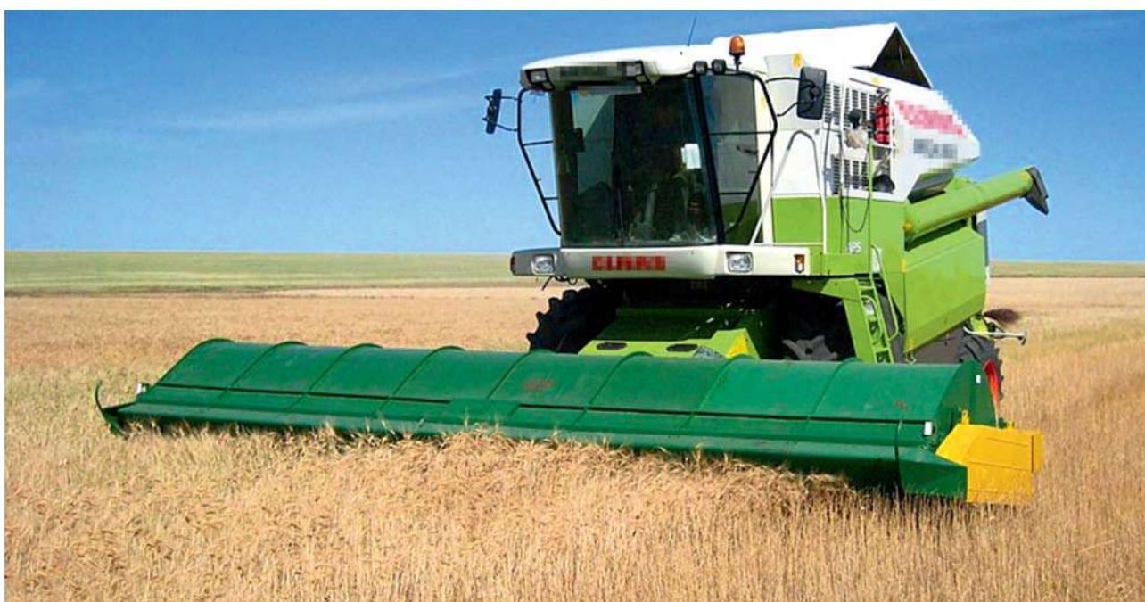
Фото 11.26. Комбайн оборудован очесывающей жаткой (stripper header)
