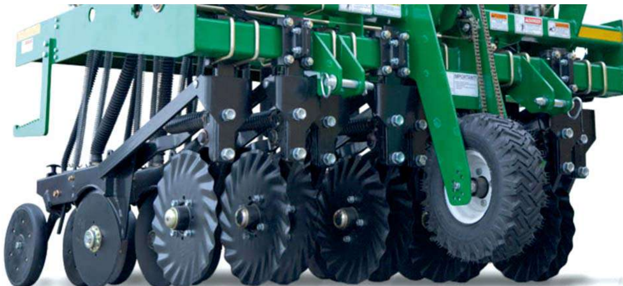
Фото 11.9. Сеялка для зерновых культур с режущим диском перед сошником
