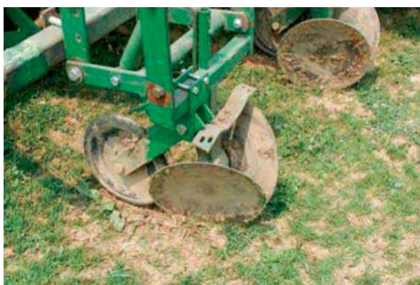
Фото 11.7. Очищающее оборудование с вогнутыми дисками
