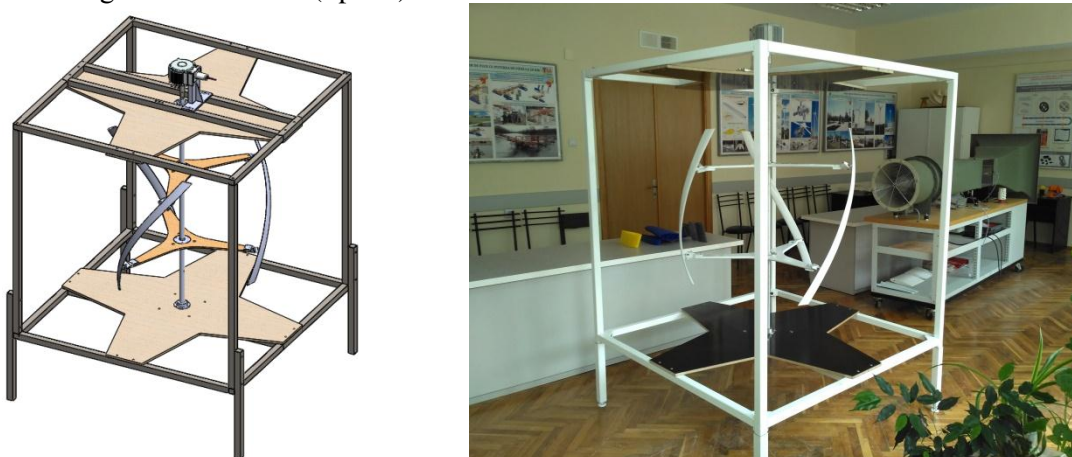
Fig. 4. Rotorul eolian cu ax vertical, tripal, cu geometrie elicoidală și profil NACA—0018 (UTM)
