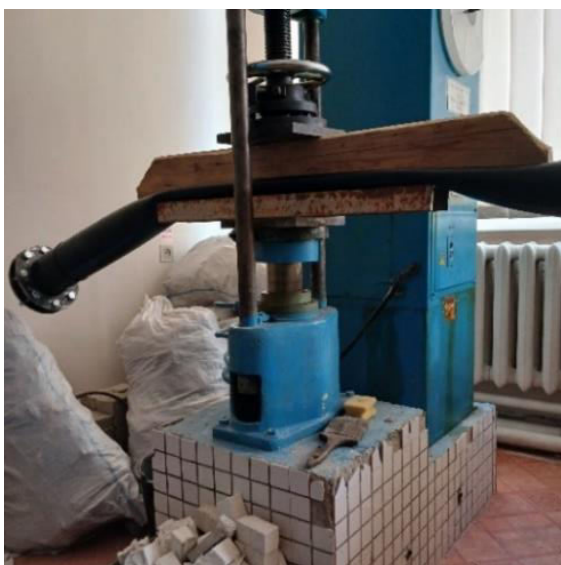
Foto 7. Deformarea mecanică a tuburilor
