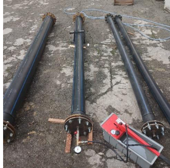
Foto 10. Restabilirea formei tubului cu pompa hidraulică
