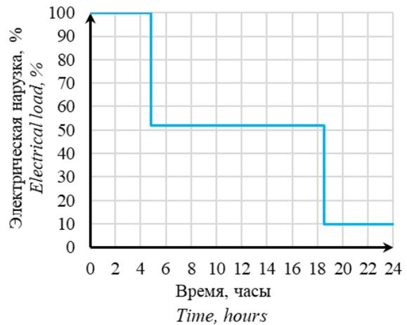
Рис.2. Пример трехступенчатого суточного зимнего графика потребителей ИСЭ. <sup>4</sup>
