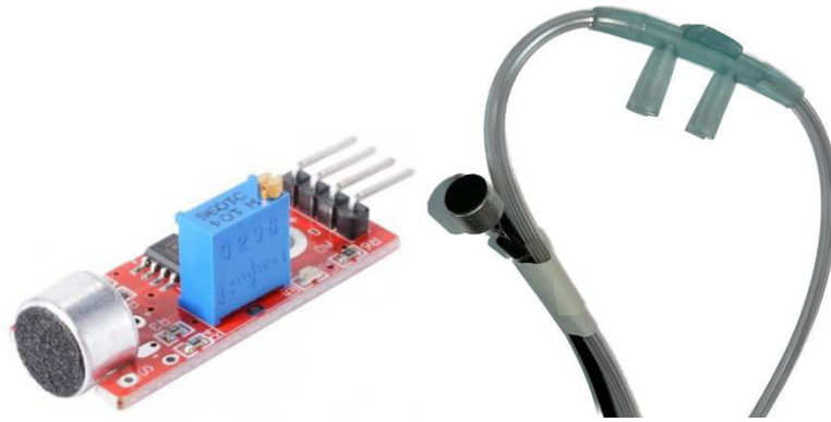
Figura 2. Modul microfon atașat la canula nazală
