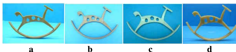
Figura 2. Jucărie turnată din diverse materiale: a) arborform, b) PHB, c) PHB + 35% coji de migdale, d) amidon [3]
