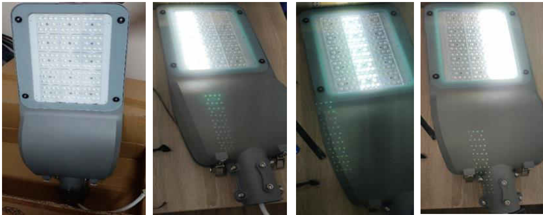
Figura 3. Corpul de iluminat stradal de tip LED elaborat și conectarea separată a benzilor LED
