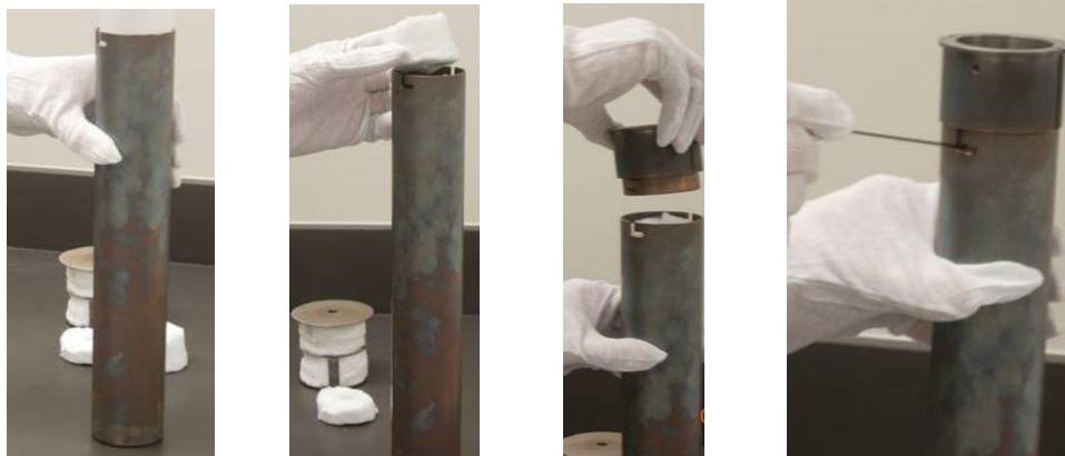
Fig. 2.23. Procesul de sigilare a celulei PS
