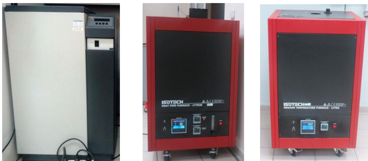
a) Instalație pentru PS_{In} , PS_{Sn} și PS_{Zn} b) Instalație pentru PS_{Al} c) Instalație pentru PS_{Ag}
