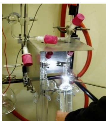
Fig. 2.14. Fabricarea celulei PTA. Sigilarea celulei la sistemul de distilare
