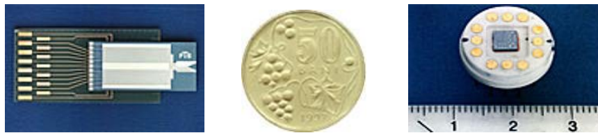
a) Etalon pe baza efectului Josephson b) Etalon pe baza efectului cuantic Hall
