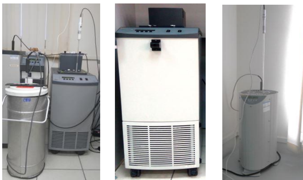
a) Instalații pentru PTA b) Instalație pentru PT Hg c) Instalație pentru PT Ga
