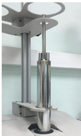
Fig. 2.25. Celula punctului triplu al mercurului din etalon
