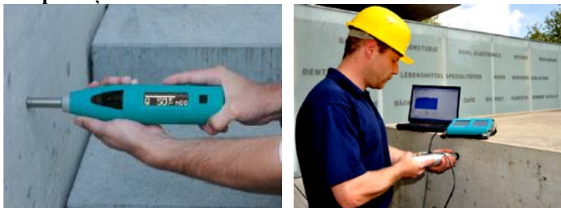
Figura 8. Efectuarea încercărilor cu aparatul Digi-Schmidt
