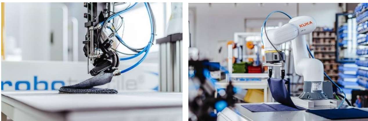
Figura 3. Roboți KUKA pentru manipularea pieselor din țesături de diferită grosime, flexibilitate și configurație [4]
