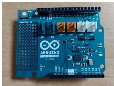
Figura 2. Placa 9 axis motion shield cu senzorul BNO055
