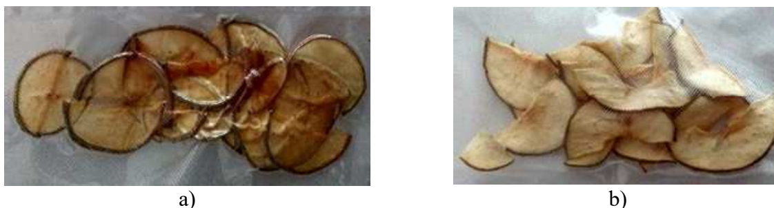
Figura 4.11 Perele „Conferința” uscate prin metoda convectivă cu utilizarea agentului de uscare ( v = 1,5 \pm 0,13 m/s): a) aer; b) atmosfera modificată de CO 2
