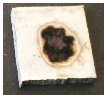
Fig. A2.5-1. Pata de grafit obținută prin descărcare electrică în impuls la tensiune de 200 V și o capacitate de 400 \mu F de la distanță de 1mm stânga și 1,5 mm dreapta
