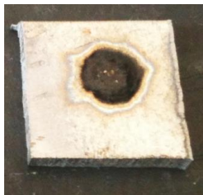
Fig. A2.4.1-1. Pata de grafit obținută prin descărcare electrică în impuls la tensiune de 200 V și o capacitate de 400 \mu\text{F} de la distanță de 1mm
