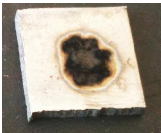
Fig. A2.4.2-1. Pata de grafit obținută prin descărcare electrică în impuls la tensiune de 200 V și o capacitate de 400 \mu F de la distanță de 1,5mm
