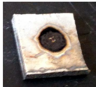
Fig. A2.2.2-1. Calitatea peliculei de grafit obținută prin descărcări electrice în impuls la o capacitate de 400 \mu F, 1 mm
