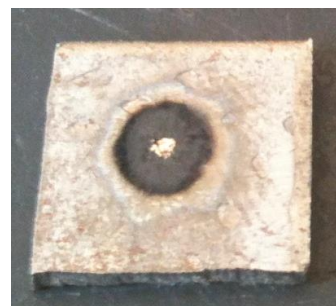
Fig. A2.4.1-4. Pata de grafit obținută prin descărcare electrică în impuls la tensiune de 250 V și o capacitate de 600 \mu\text{F} de la distanță de 1mm
