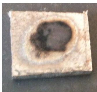
Fig. A2.6.2-2. Pata de grafit obținută prin descărcare electrică în impuls la tensiune de 250 V și o capacitate de 500 \mu F de la distanță de 1,5 mm
