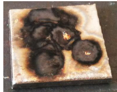
Fig. A2.1-2. Calitatea peliculei de grafit în funcție de numărul de descărcări aplicate într-un punct (10-16)
