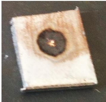
Fig. A2.5-3. Pata de grafit obținută prin descărcare electrică în impuls la tensiune de 250 V și o capacitate de 500 \mu F de la distanță de 1mm stânga și 1,5 mm dreapta
