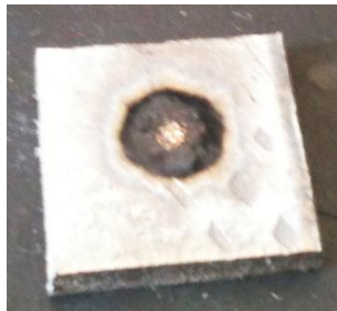
Fig. A2.2.2-3. Calitatea peliculei de grafit obținută prin descărcări electrice în impuls la o capacitate de 600 \mu F, 1 mm
