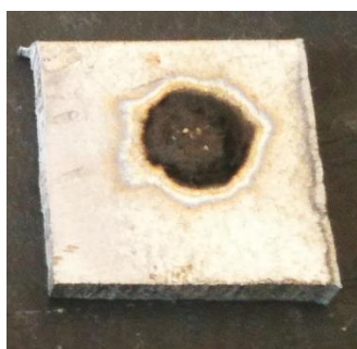
Fig. A2.5-1. Pata de grafit obținută prin descărcare electrică în impuls la tensiune de 200 V și o capacitate de 400 \mu F de la distanță de 1mm stânga și 1,5 mm dreapta
