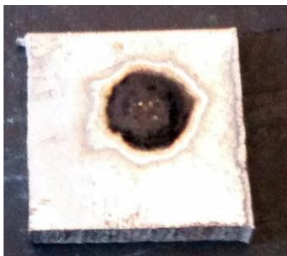
Fig. A2.2.2-1. Calitatea peliculei de grafit obținută prin descărcări electrice în impuls la o capacitate de 400 \mu F, 1 mm
