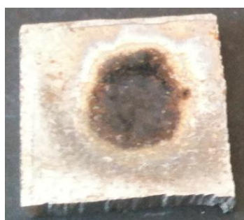
Fig. A2.6.2-1. Pata de grafit obținută prin descărcare electrică în impuls la tensiune de 250 V și o capacitate de 400 \mu F de la distanță de 1,5 mm
