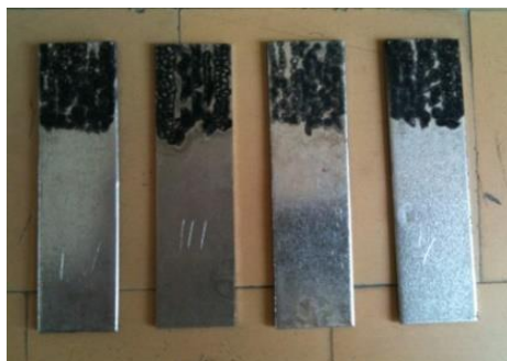
Fig. 2.9. Epruvete cu peliculă de grafit depusă prin descărcări electrice în impuls
