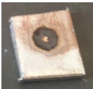
Fig. A2.4.1-3. Pata de grafit obținută prin descărcare electrică în impuls la tensiune de 200 V și o capacitate de 500 \mu\text{F} de la distanță de 1mm
