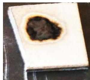
Fig. A2.4.2-2. Pata de grafit obținută prin descărcare electrică în impuls la tensiune de 250 V și o capacitate de 400 \mu F de la distanță de 1,5mm
