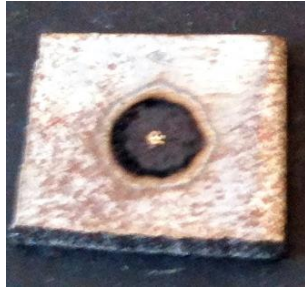
Fig. A2.2.2-2. Calitatea peliculei de grafit obținută prin descărcări electrice în impuls la o capacitate de 500 \mu F, 1 mm
