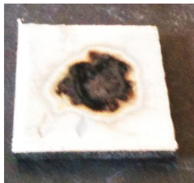
Fig. A2.6.1-2. Pata de grafit obținută prin descărcare electrică în impuls la tensiune de 200 V și o capacitate de 500 \mu F de la distanță de 1,5 mm
