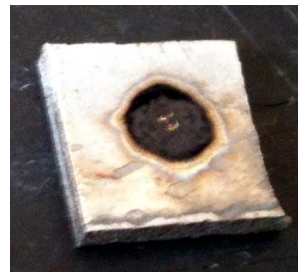
Fig. A2.3-1. Comparație între petele de grafit obținute în urma descărcărilor electrice în impuls la 400 de \mu F la 1,5 mm (stânga) și 1 mm (dreapta)
