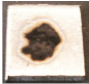
Fig. A2.2.1-2. Calitatea peliculei de grafit obținută prin descărcări electrice în impuls la o capacitate de 500 \mu F, 1.5 mm
