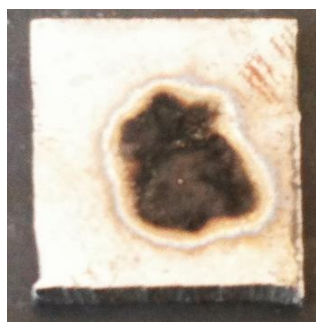
Fig. A2.2.1-1. Calitatea peliculei de grafit obținută prin descărcări electrice în impuls la o capacitate de 400 \mu F, 1,5 mm
