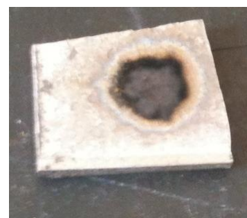
Fig. A2.6.2-3. Pata de grafit obținută prin descărcare electrică în impuls la tensiune de 250 V și o capacitate de 600 \mu F de la distanță de 1,5 mm
