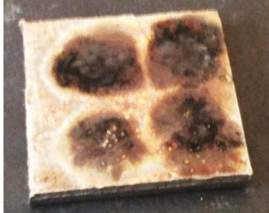
Fig. A2.1-1. Calitatea peliculei de grafit în funcție de numărul de descărcări aplicate într-un punct (2-10)
