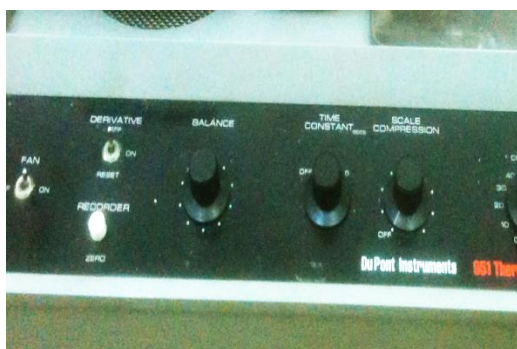
Fig. A3.1.5. Zona de comandă și reglaj a aparatului
