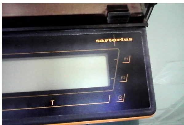
Fig. A3.6.2. a și b: Balanță analitică tip SARTORIUS precizie 0,0001g.
