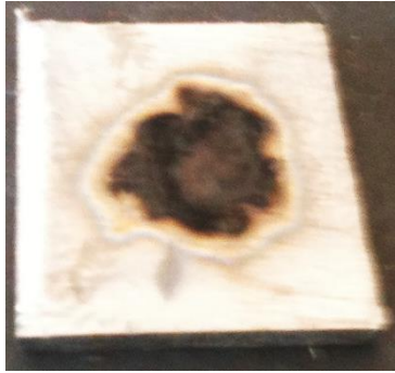
Fig. A2.2.1-2. Calitatea peliculei de grafit obținută prin descărcări electrice în impuls la o capacitate de 500 \mu F, 1.5 mm
