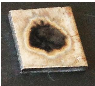
Fig. A2.4.2-3. Pata de grafit obținută prin descărcare electrică în impuls la tensiune de 250 V și o capacitate de 500 \mu F de la distanță de 1,5mm
