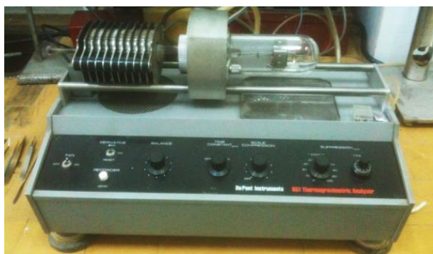
Fig. A3.1.1 Termogravimetru tip Du Pont Instruments 951
