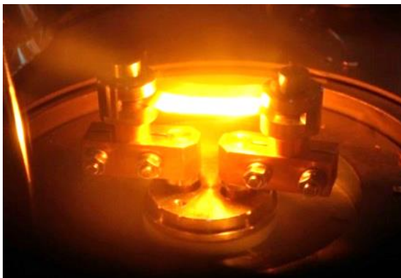
Fig. 1.3. Camera cu vid pentru depunere evaporativă [25]
