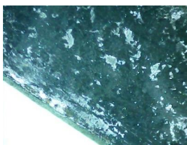
Fig. 2.10. Morfologia suprafeței tratate urmărită la microscop mărită \times 80
