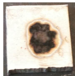
Fig. A2.2.1-1. Calitatea peliculei de grafit obținută prin descărcări electrice în impuls la o capacitate de 400 \mu F, 1,5 mm
