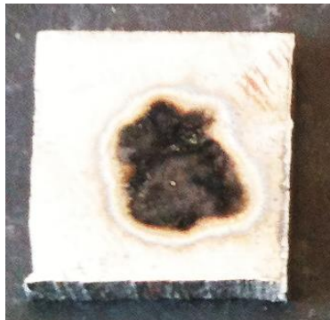
Fig. A2.6.1-1. Pata de grafit obținută prin descărcare electrică în impuls la tensiune de 200 V și o capacitate de 400 \mu F de la distanță de 1,5 mm
