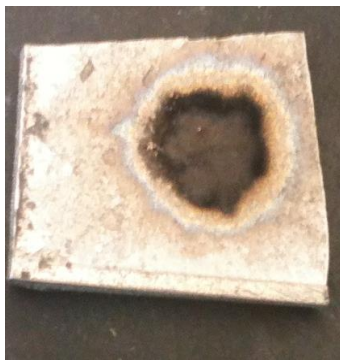
Fig. A2.2.1-3. Calitatea peliculei de grafit obținută prin descărcări electrice în impuls la o capacitate de 600 \mu F, 1.5 mm
