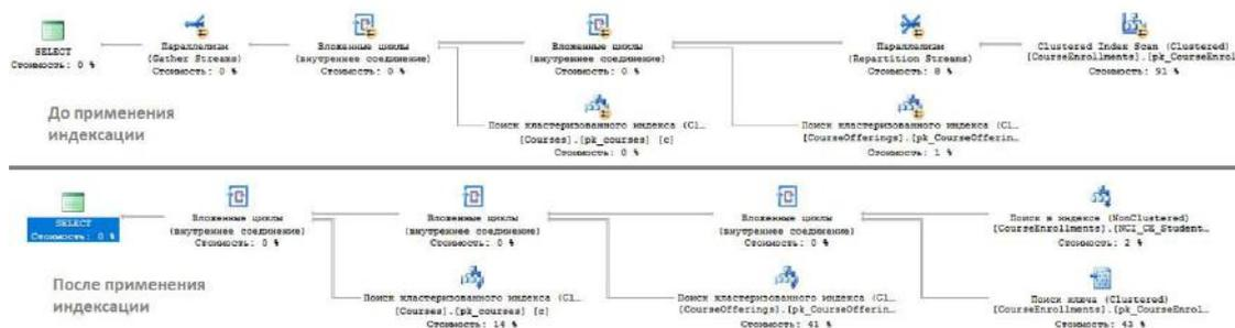
Рис.5. Вид планов выполнения до и после индексации
