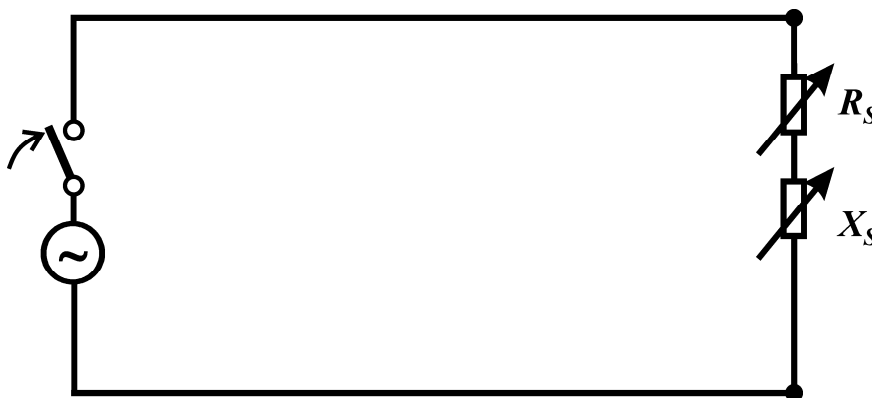
Рис. 4. Линия переменного напряжения с активной R_S и реактивной X_S нагрузкой на приемном конце
