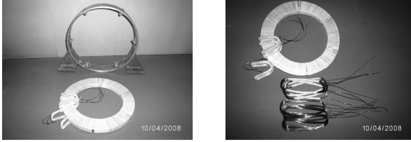
Fig. 5 La technologie de la confection du stator du générateur synchrone à aimants permanents sans entailles sur le paquet statorique
