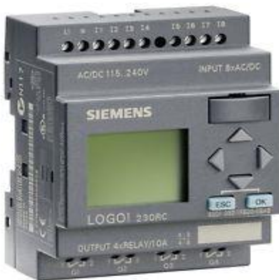
Figura 1. Controlerul SIEMENS LOGO un
