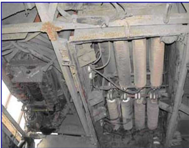
Fig.3. Sistemul reostatic de reglare al troleibuzului
