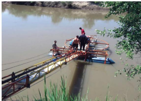
Microhidrocentrala cu rotor hidrodinamic (MHCF D4x1,5 M) pentru pomparea apei în lacuri de acumulare, a fost instalată în a.2009 pe r.Prut, c. Stoienești, Cantemir.
