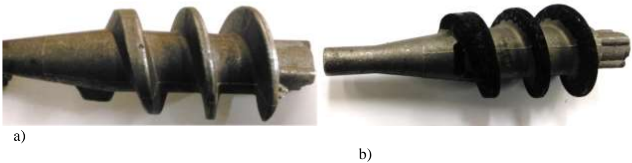
Fig. 2. Vederea generală a melcului mașinii de brichetat înainte de prelucrare (a) și cu acoperire (b)
