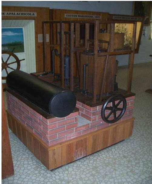
Рисунок 1. Первая воздушная холодильная машина, изобретённая Дж. Горри
