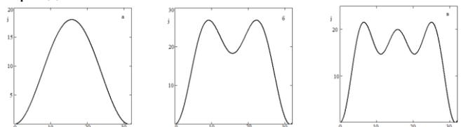
Рис.1 Пространственная структура траектории пучка при значении поправки к постоянной распространения  $\alpha = 0,2$  и различных значениях констант связи первого, второго и третьего порядков: а.  $\gamma_1 = 0,9$ ,  $\gamma_2 = 0,012$ , и  $\gamma_3 = 0,001$ ; б.  $\gamma_1 = 0,9$ ,  $\gamma_2 = 0,83$ , и  $\gamma_3 = 0,015$ ; в.  $\gamma_1 = 0,5$ ,  $\gamma_2 = 0,499$ , и  $\gamma_3 = 0,05$ .
