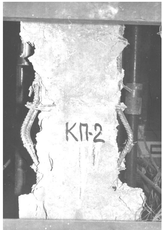
Рис. 1.23. Выпучивание контурной арматуры и разрушение сжатой зоны бетона в панелях при испытаниях многократно повторяющейся горизонтальной нагрузкой.
