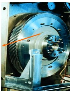
Fig. 2. Angrenaje ale mașinii de tipărit [2]
