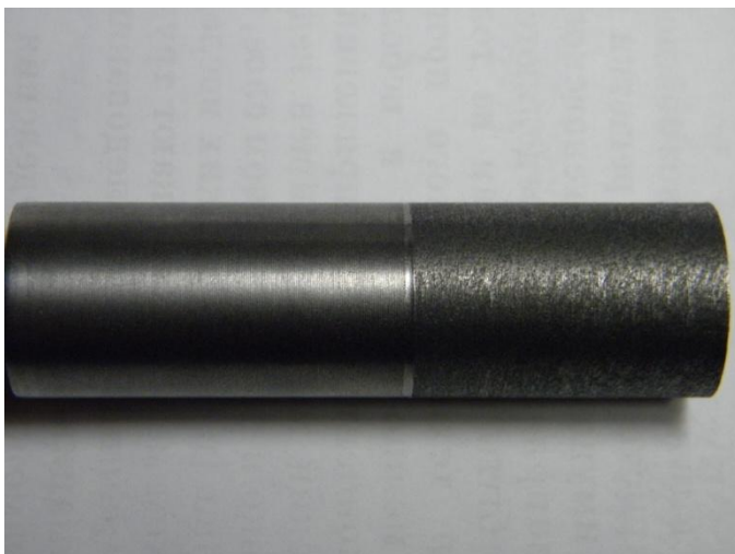
Fig 4.8. Epruvetele netezite pe strung normal
