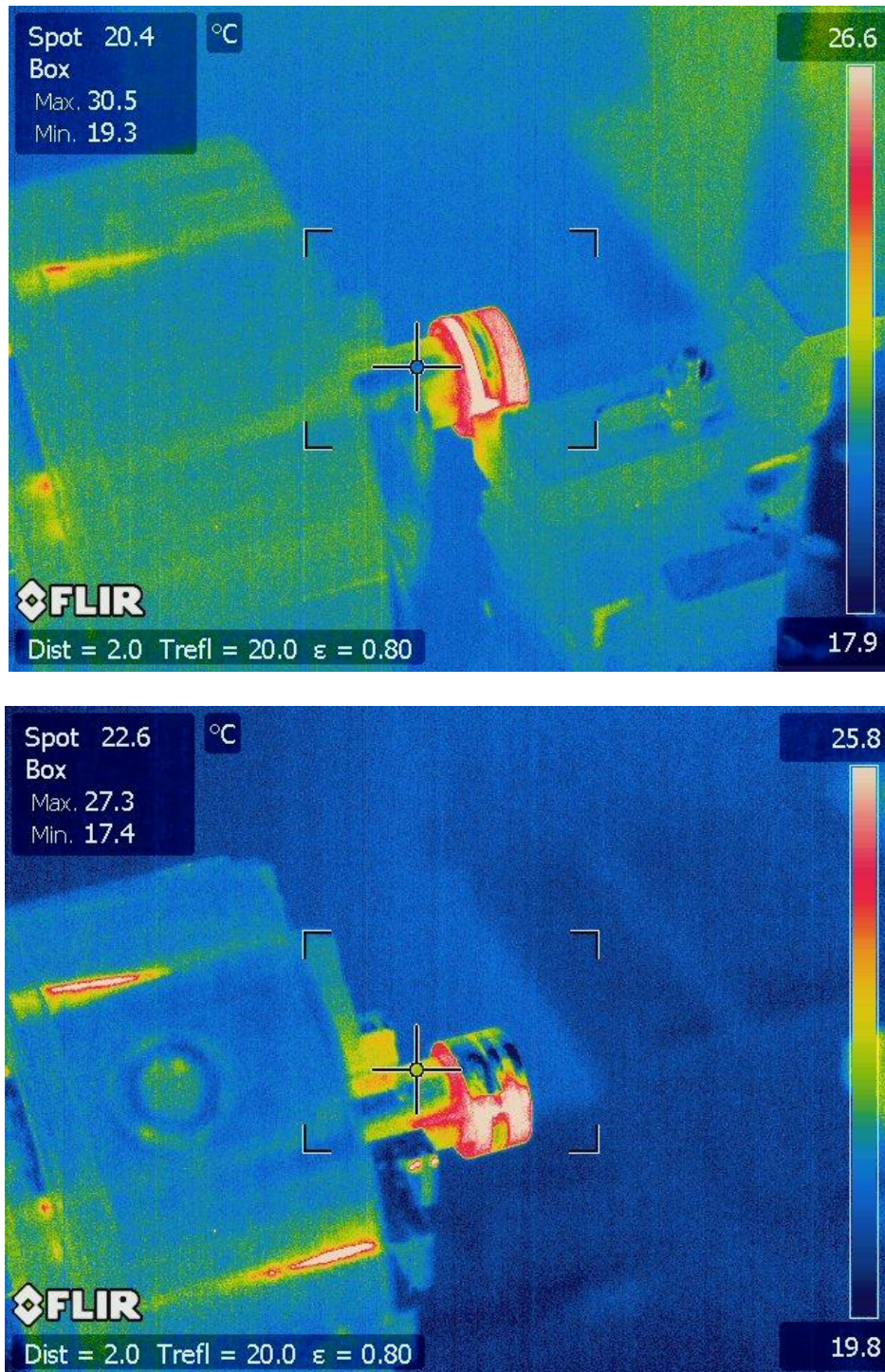
Fig. 4.6. Imagini ale regimului termic din timpul desfășurării procesului de deformare plastică la rece prin netezire și durificare cu bila de rulment
