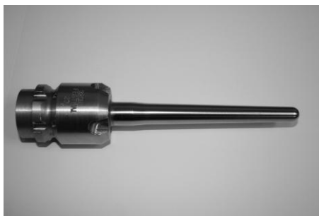
a) b) Fig. 4.10. Vederea generală a plunjoarelor formelor de turnare a sticlei: a) neprelucrat; b) prelucrat cu aplicarea DEI
