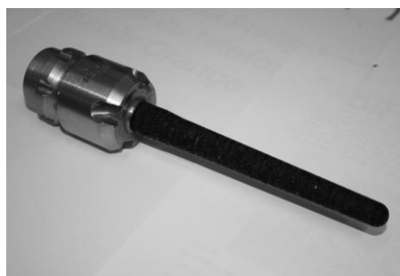
a) b) Fig. 4.10. Vederea generală a plunjoarelor formelor de turnare a sticlei: a) neprelucrat; b) prelucrat cu aplicarea DEI
