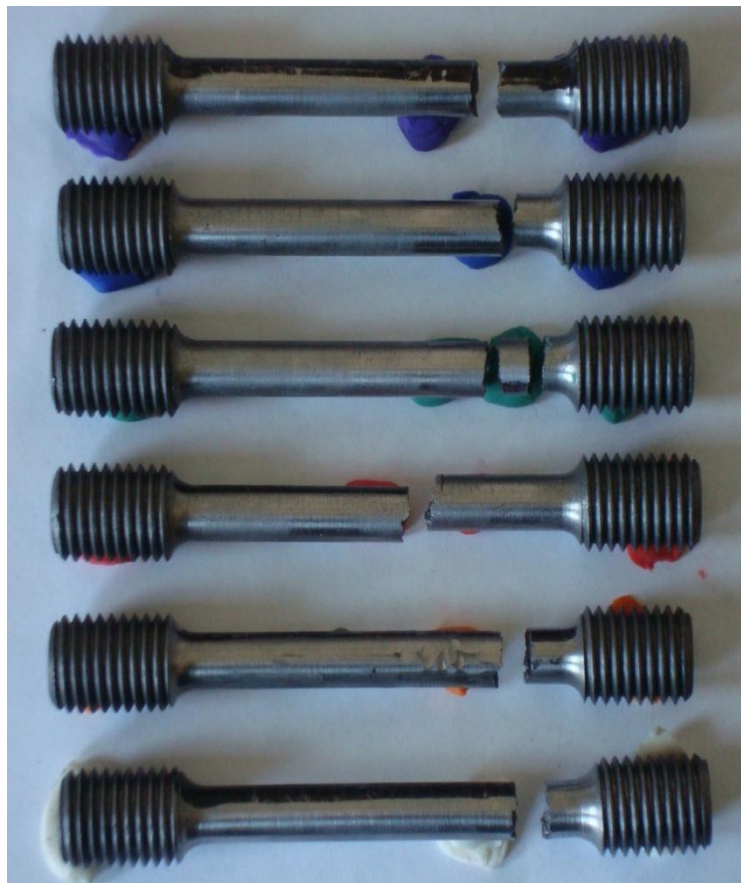
Fig. 2.30. Reprezentarea epruvetelor după încercări: a) la compresiune; b) la tracțiune.
