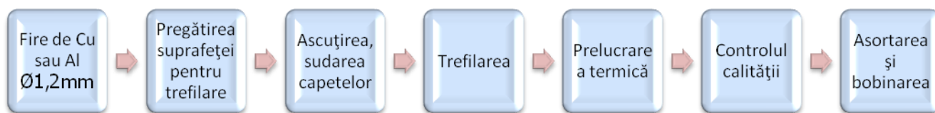
Fig.2 Schema procesului tehnologic de trefilare [1]
