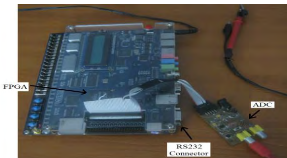
Рис.1.12. Макетный образец устройства для реализации спектрального анализа ограниченного во времени сигнала.
