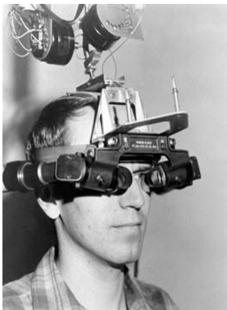
Figura 1.1. Reprezentarea primului dispozitiv pentru utilizarea AR, „Sabia lui Damocles”
