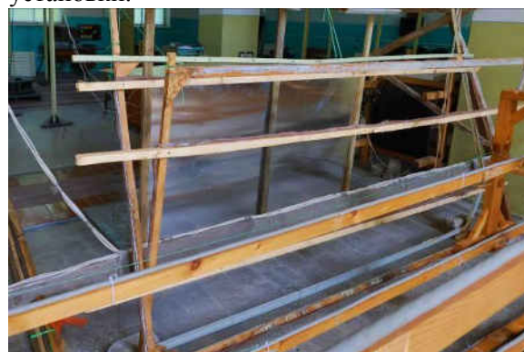
Рис. 12. Две компенсирующие обмотки САЭ макета экспериментальной установки. 12
