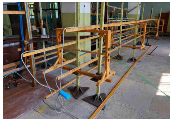
Рис. 11. Макет экспериментальной установки одноцепной ЛЭП с треугольным расположением проводов. 11
