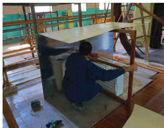
Рис. 13. Пассивный П-образный экран макета экспериментальной установки. 13
