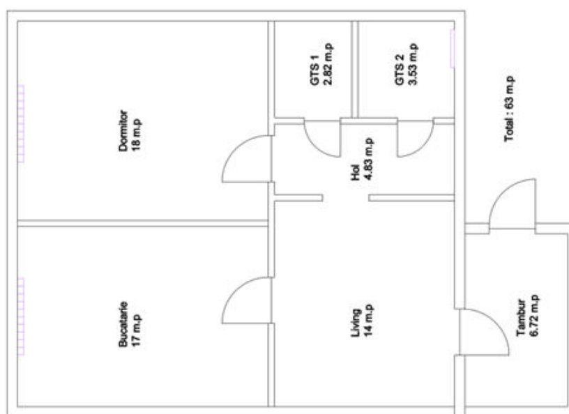
Figura 2. Schița Apartamentului cu amplasarea caloriferelor
