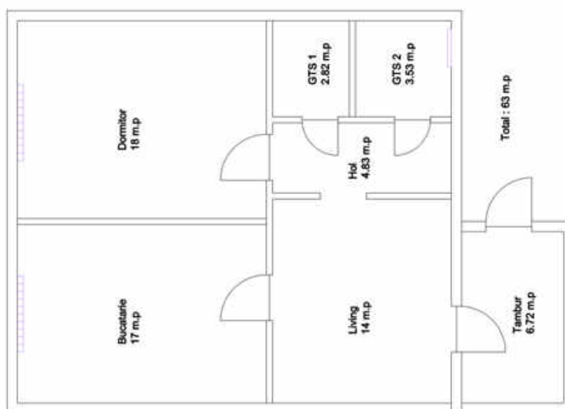
Figura 2. Schița Apartamentului cu amplasarea caloriferelor
