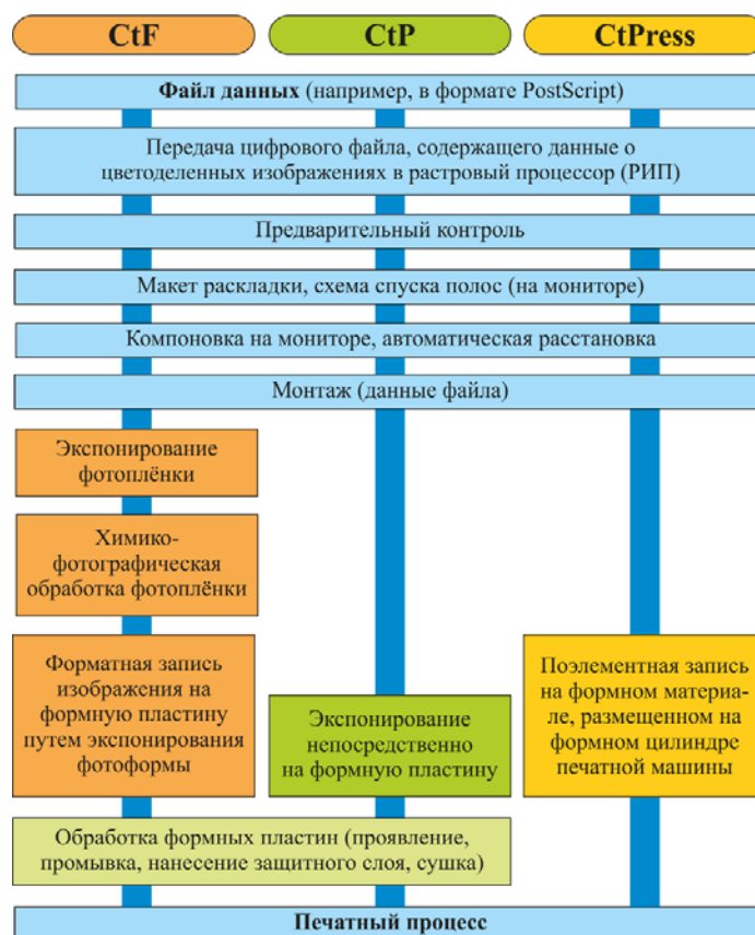
Рисунок 2. Процесс изготовления печатных форм с использованием допечатных формных технологий
