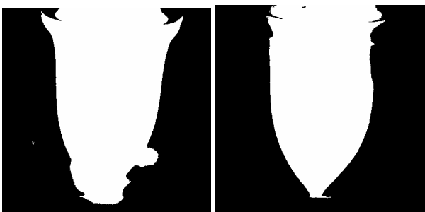
Fig 2. Imaginea picăturii după segmentare cu T_{B1}=100 și T_{B2}=165 .
